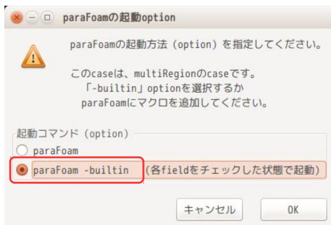
multiRegion の case 場合、paraFoam をオプション無しで起動すると、起動後、各 region を読み込む必要があり、region が多くあると、手間がかかる。「paraFoam -builtin」で paraFoam を起動すると、全 region の全 field を読み込む設定で paraFoam が起動するので、結果が直ぐに確認できるが、欠点もあるので、状況に合わせて確認する。(9-6-1-11 項を参照)
