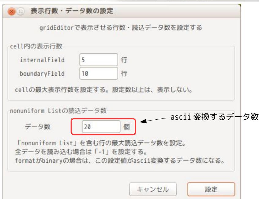
この後、分けて読み込んだ ascii 部のデータに、ascii 変換した binary 部を挿入して、ascii ファイルとして完成させる。でき上がった ascii ファイルを「TreeFoam/temp/」フォルダに「U.0/U」として保存し、このファイルを editor で読み込み編集する方法をとっている。
