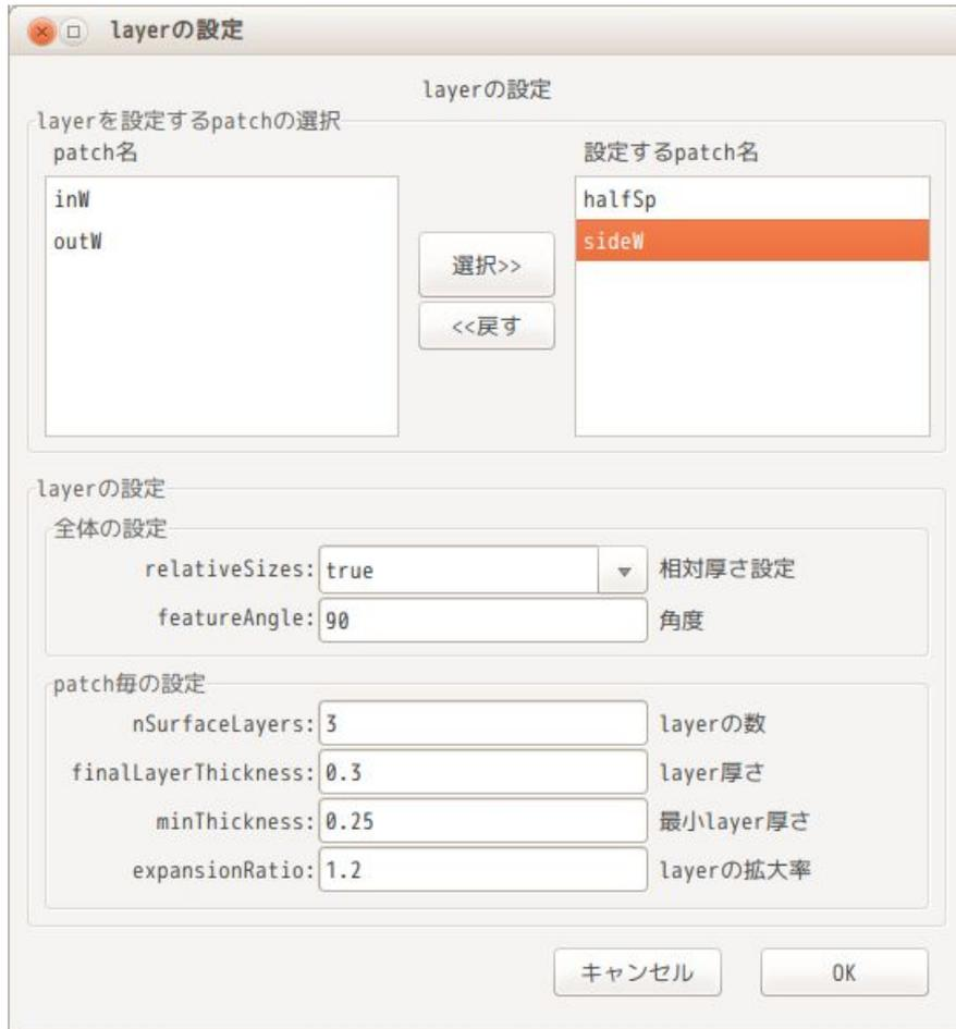
この設定で、レイヤを追加してみる。レイヤを追加するためには、「layer 作成」ボタンをクリックする。これにより、snappyHexMeshを実行し、レイヤが追加される。
