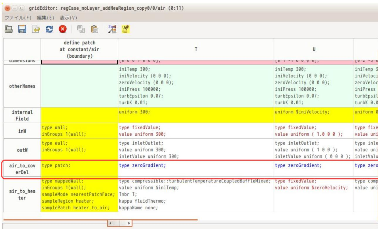
「heater」 region の場合も同様に、cover と接していた「heater\_to\_cover」が「heater\_to\_coverDel」に変更され、patchType も「mappedWall」から「patch」変更され、全ての field の patch 内容が「zeroGradient」に変更される。
