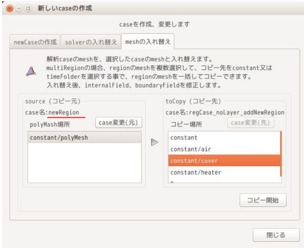
以上の操作で、メッシュがコピーされたので、この形状を paraFoam で確認すると、以下の様に、cover が追加されている事が確認できる。
