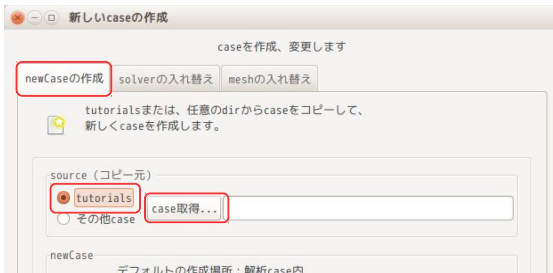
この後、以下の画面が現れるので、区分「multiphase:多層流」、solver「interFoam」、case「laminer/damBreak」を選択し、「OK」ボタンをクリックする。
