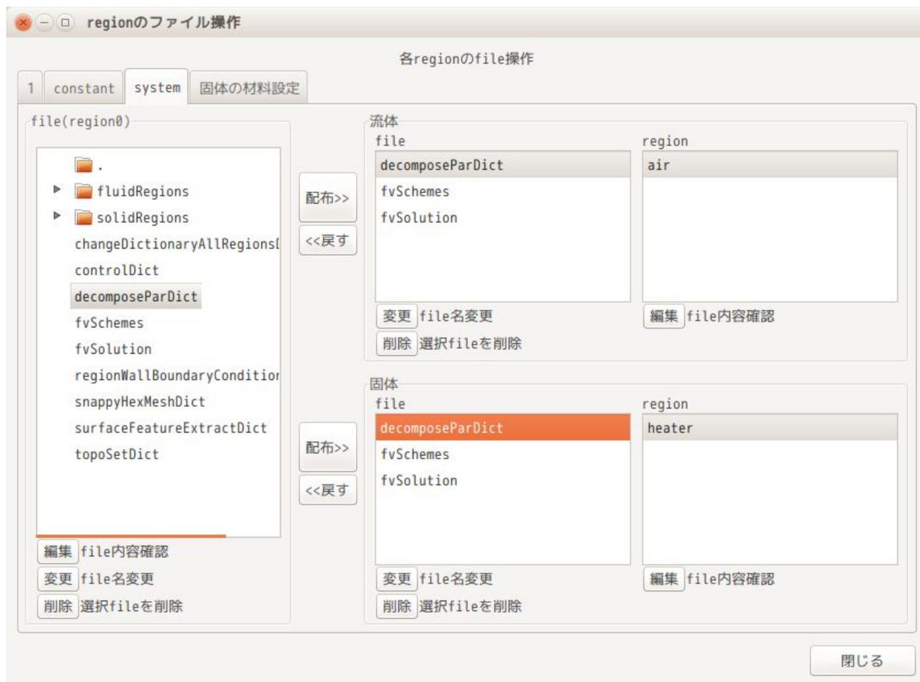
decomposeParDict を完成させた後は、6-2-7 項と同様に「mesh 分割」ボタンでメッシュを processor 毎に分割し、「並列計算開始」ボタンで、計算を開始させる。
