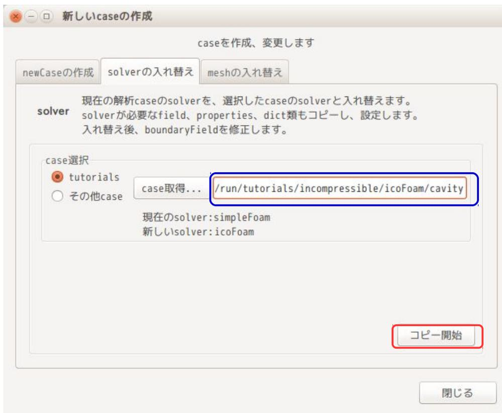
solver を入れ替える操作は、コピー先の case から以下の file をコピーしてくる。
