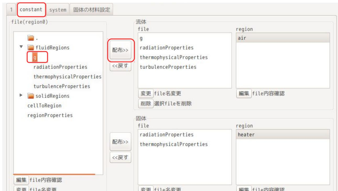
以下が「g」を開いて、重力加速度の方向を Z 軸方向に修正した状態。修正後、上図の「配布>>」ボタンをクリックして、流体 region にコピー配布する。region「air」内の g ファイルを直接編集しても構わない。
