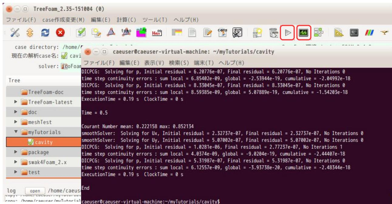
また、実行中 (実行後) の残渣を確認するには、📊 ボタンをクリックすると、残渣が以下の様に表示される。端末を起動した上で plotWatcher を起動している為、閉じる時は端末も閉じておく。
