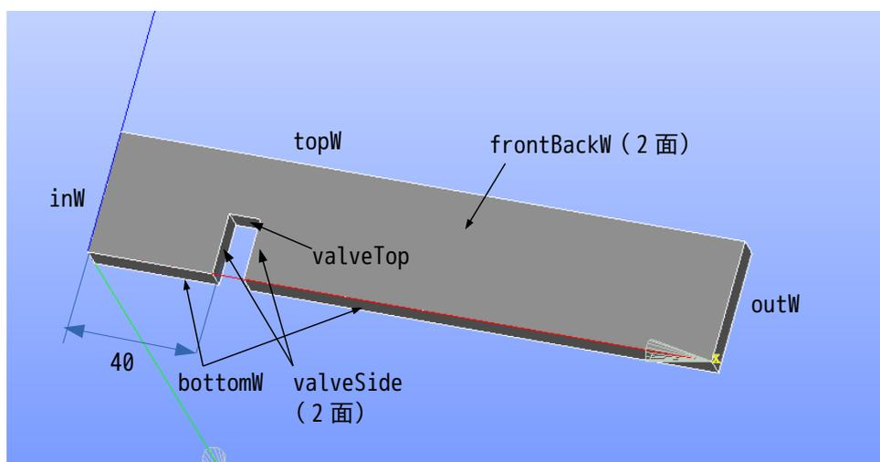
解析は、valveTop 部を上方へ移動させ、ダクトを狭める様に移動 (流路が次第に狭くなっていく) させた場合の流速や圧力分布を確認する。
