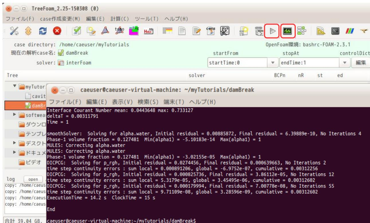
下図が実行中（実行後）に
