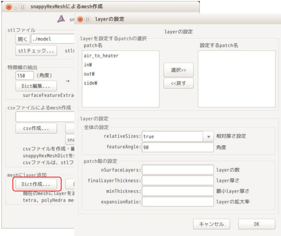
レイヤを付ける patch は、「air\_to\_heater」と「sideW」になるので、それぞれ、以下で作成している。レイヤは、絶対寸法で指定する様に設定し、レイヤの厚さのみをそれぞれで変更して設定している。
