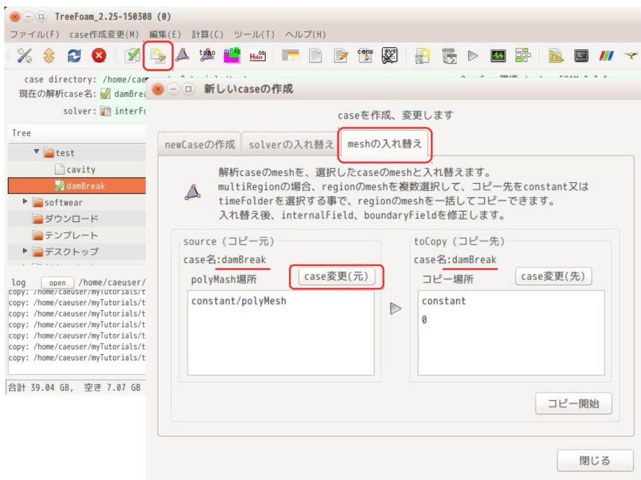
上記「新しい case の作成」画面内は、メッシュのコピー元、コピー先とも「damBreak」に設定されているので、コピー元を「cavity」に設定する。この為に、「case 変更 (元)」ボタンをクリックして、「cavity」に変更する。以下がコピー元を「cavity」に変更した状態になる。
