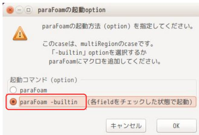
この方法で paraFoam を起動すると、各 region、各 field のデータを読み込んだ状態で paraFoam が起動する。
