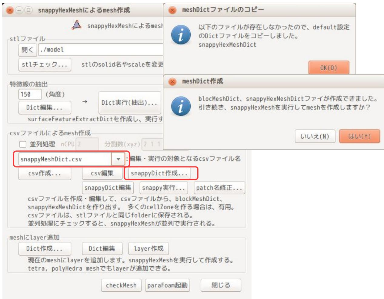
「snappy 実行...」ボタンをクリックしても、blockMesh と snappyHexMesh を実行してメッシュを作成する事ができる。この場合は、予め 7-1-3 項で特徴線を抽出しておく必要がある。またこの方法は、boundaryField の整合を取ってくれないので、paraFoam でメッシュを確認する為には、引き続き「patch 名修正...」ボタンをクリックして boundary の整合性をとり、余分な patch 名削除を行っておく必要がある。
