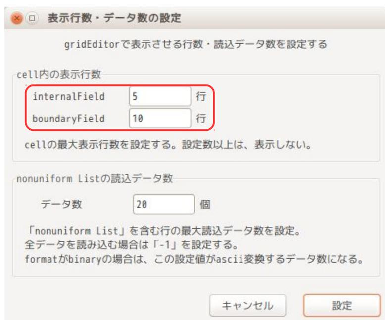
上記画面上で、internalFieldは5行、boundaryFieldは10行に設定されている。この行数を両方共6行に設定して、gridEditorを表示させた結果が以下になる。6行に変更されて表示されている。
