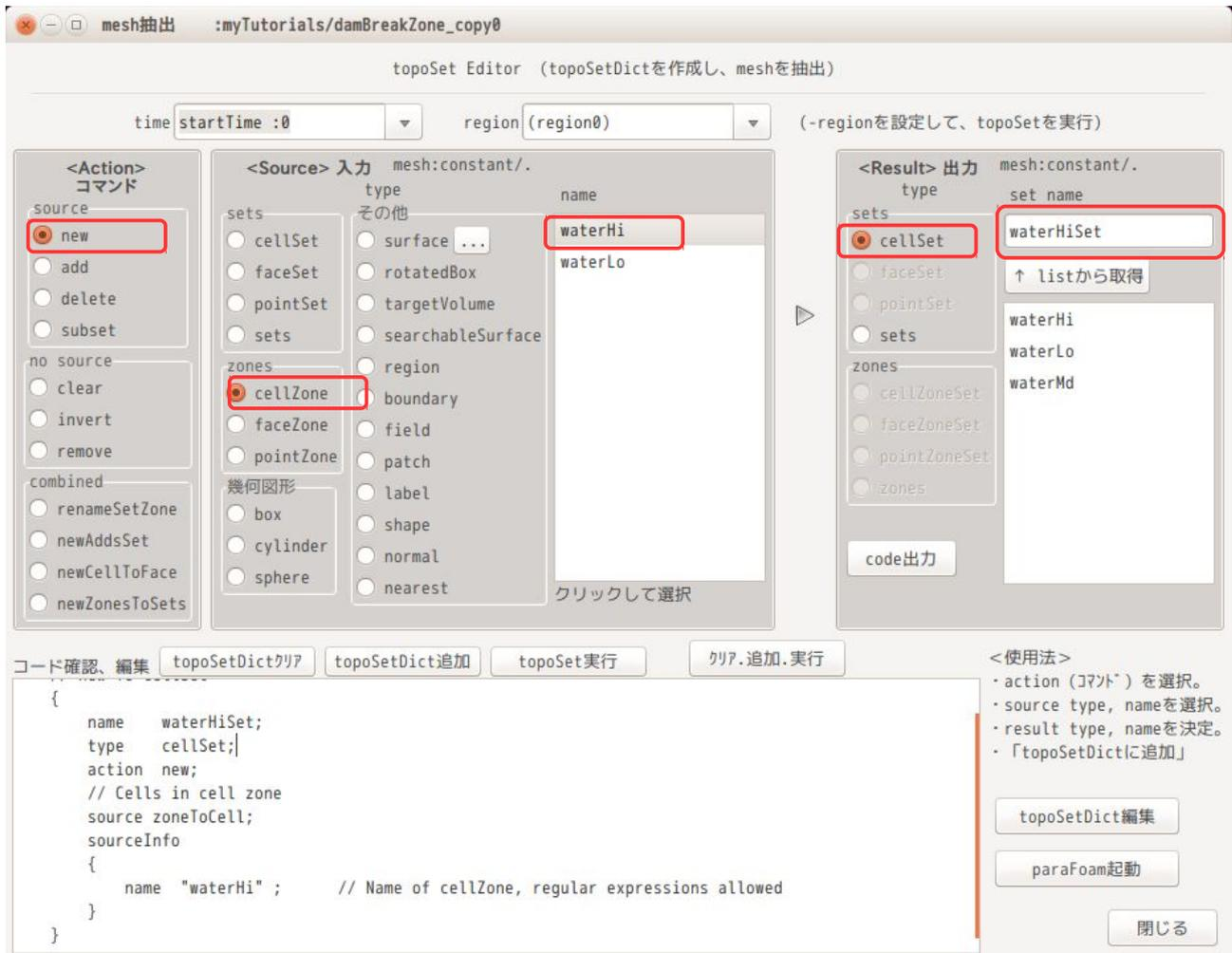
今回の場合、表示された topoSetDict の内容は修正する必要がなく、このまま topoSetDict として使えるので、1)項と同様に「topoSetDict クリア」「topoSetDict 追加」「topoSet 実行」ボタンを順にクリックすることで、cellSet「waterHiSet」が作成できる。
