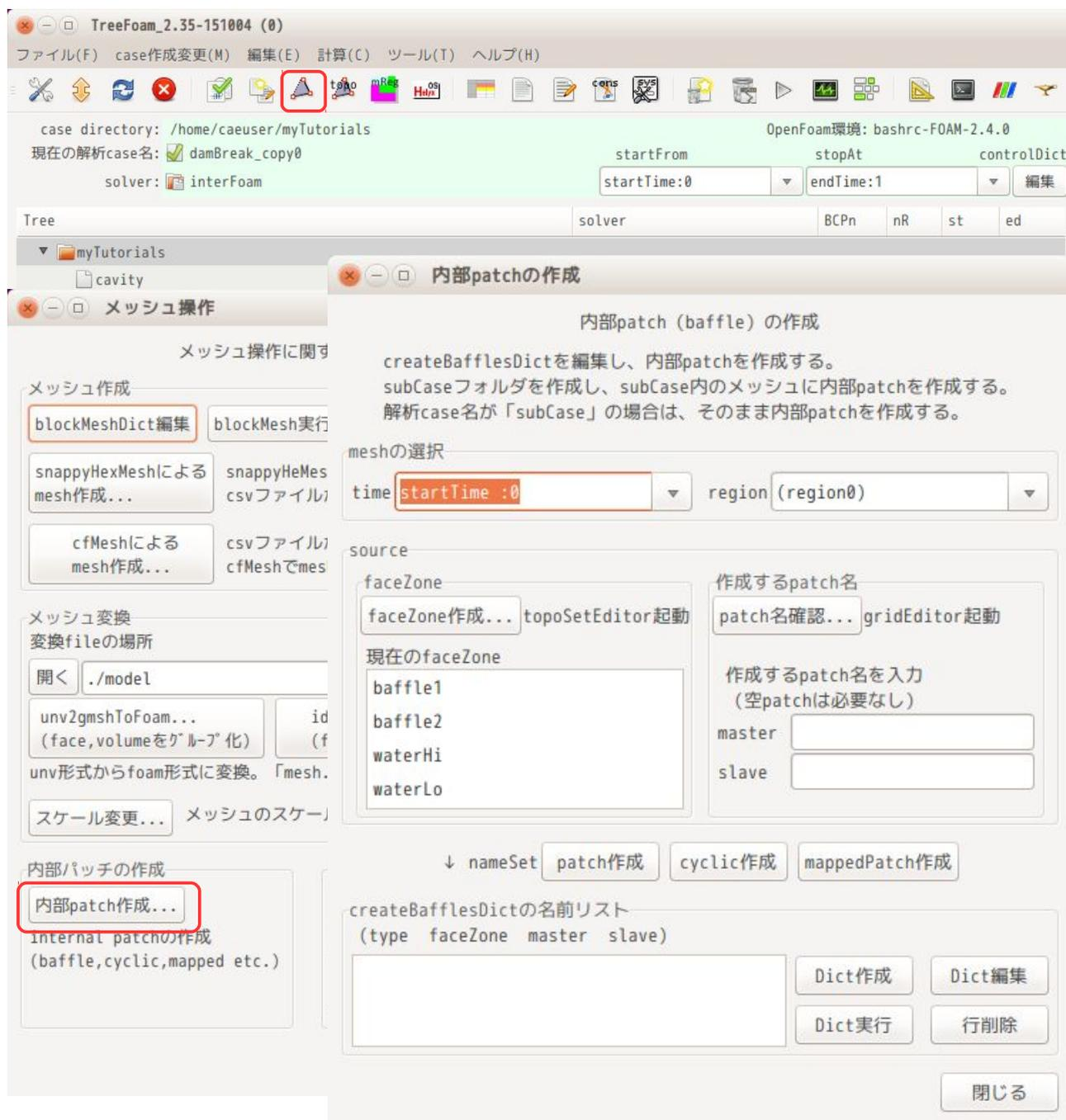
内部パッチ (baffle) は、上図「内部 patch の作成」画面上から、作成したい faceZone を指定して baffle を作り出す事になる。今回は、faceZone 「baffle1」「baffle2」を使って、baffle 「baffle1」「baffle2」を作成する。
