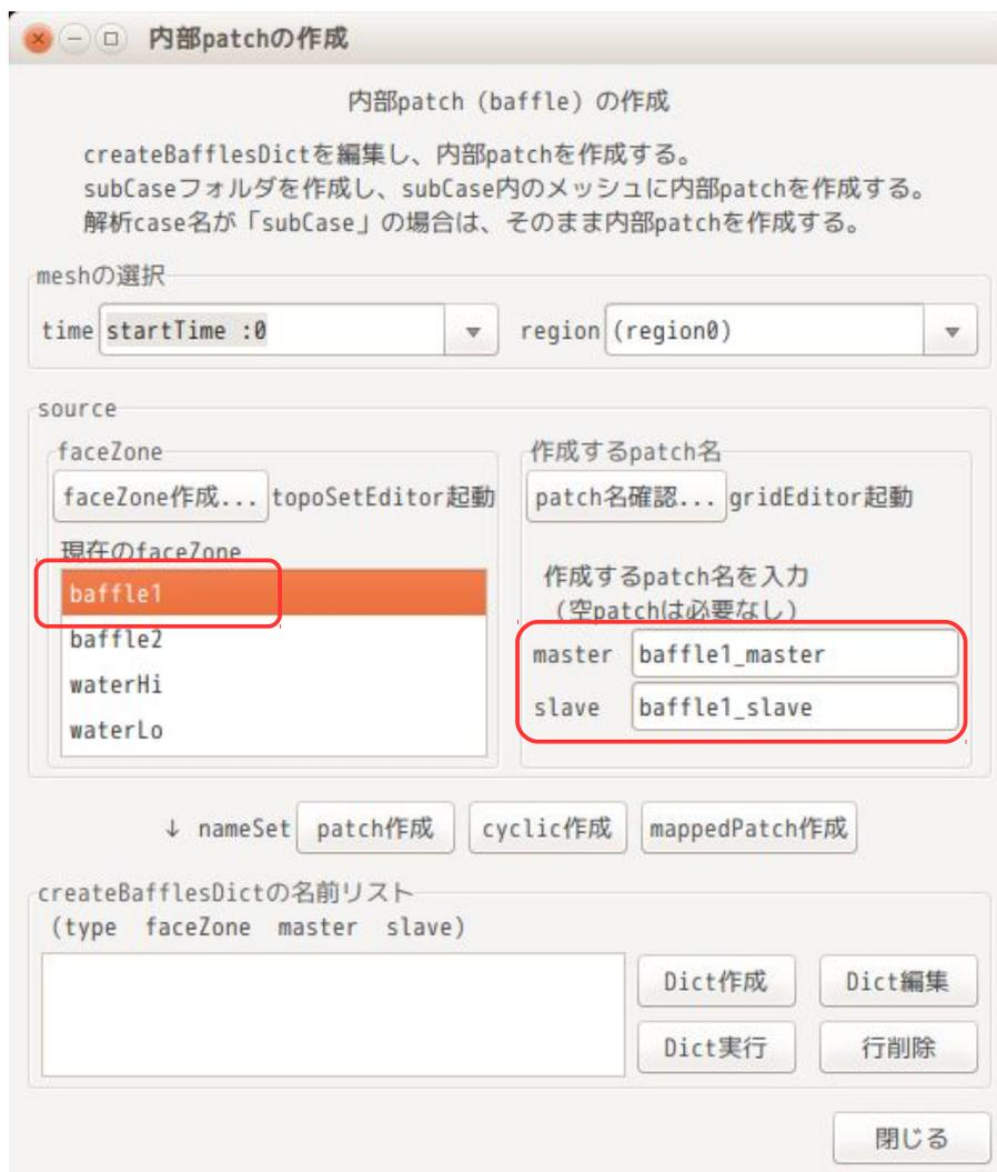
今回の場合、baffleを作成するので、以下の様に、master、slaveとも、同じ名前「baffle1」に変更する。変更後、「patch作成」ボタンをクリックして、名前リストに追加する。
