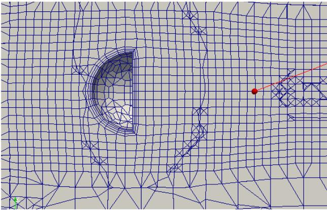
前記した方法で、レイヤがうまく追加されない（部分的にレイヤが欠けるなど）場合は、レイヤの厚さを cell サイズに対する相対寸法で設定するのではなく、絶対寸法で設定するとうまく設定できる。レイヤを絶対寸法で設定する場合は、以下の様に、相対厚さ設定 (relativeSizes) を「false」に設定する。
