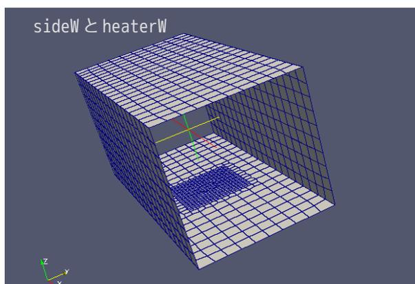
sideW と heaterW の patch に接する cover の形状は、下図の様に、厚さ 6mm に設定する。
