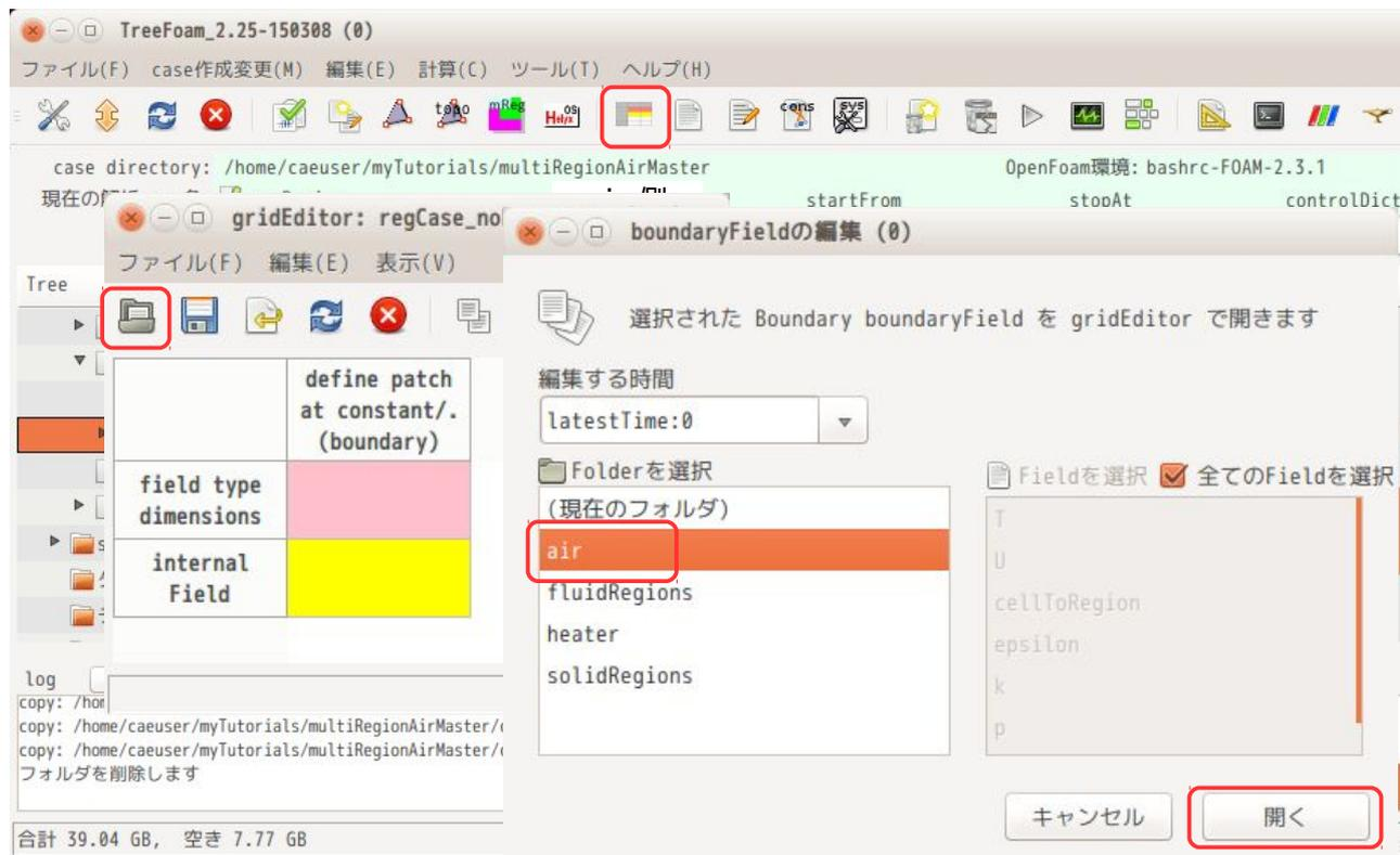
以下が、air と heater の境界条件になる。field内変数が定義され、その変数を使って region 間の境界条件が設定されている。
