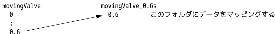
データのマッピング方法は、マッピングする case 「movingValve\_0.6s」を解析 case に設定した上で、TreeFoam 上の ボタンをクリックして、「Field へのデータセット」画面を表示させ、「mapFields」タグを選択する。以下この画面上で、データをマッピングする事になる。
