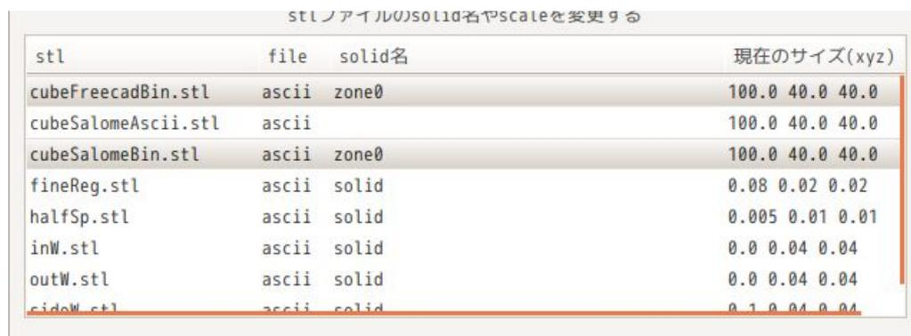
この処理は、logを見て判るように「surfaceTransformPoints -scale '(1.0 1.0 1.0)」を実行しているのみ。このコマンドを実行すると、形式を ascii に変換してくれるので、このコマンドを使っている。
