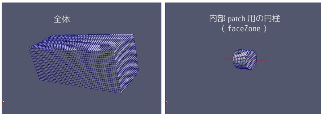
できあがったメッシュに、内部 patch を作成する為に、TreeFoam 上の
