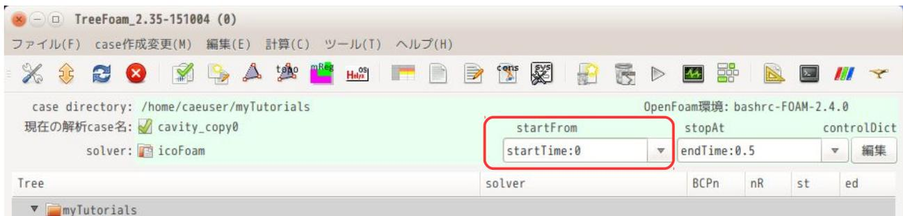
startFrom が「startTime」に設定されている事を確認後、「snappyHexMesh による mesh 作成」画面上で、「Dict 作成...」ボタンをクリックして、「layer の設定画面」を表示させる。
