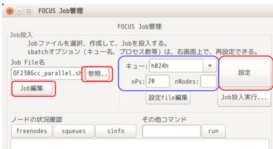
キュー、並列数 (nPs)、使用する node 数 (nNodes) は、直接テキストボックス中で修正し、「設定」ボタンをクリックする事で修正できる。
