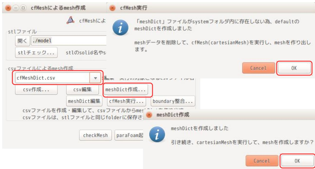
また、この画面上的「meshDict 編集」ボタンで meshDict ファイルを直接 editor で編集できる。「cfMesh 実行...」ボタンで「cartesianMesh」コマンドを実行し、メッシュを作成する事ができる。しかし、このボタンで mesh を作成した場合、できあがった mesh と field との boundary の整合が取れていないので、この状態では paraFoam で形状確認ができないが、「boundary 整合...」ボタンで、boundary の整合を取ることができ、paraFoam で形状確認ができるようになる。
