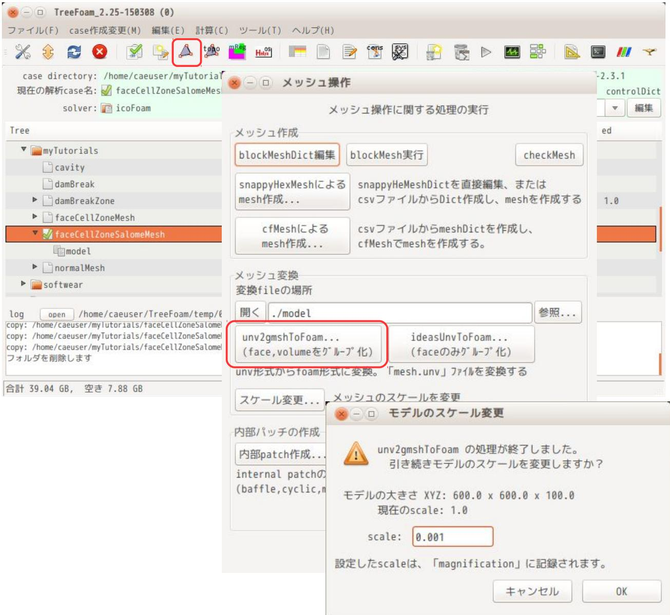
このメッシュ変換は、変換と同時に boundaryField の整合も行っているため、変換後、直ぐに paraFoam でメッシュが確認できる。
