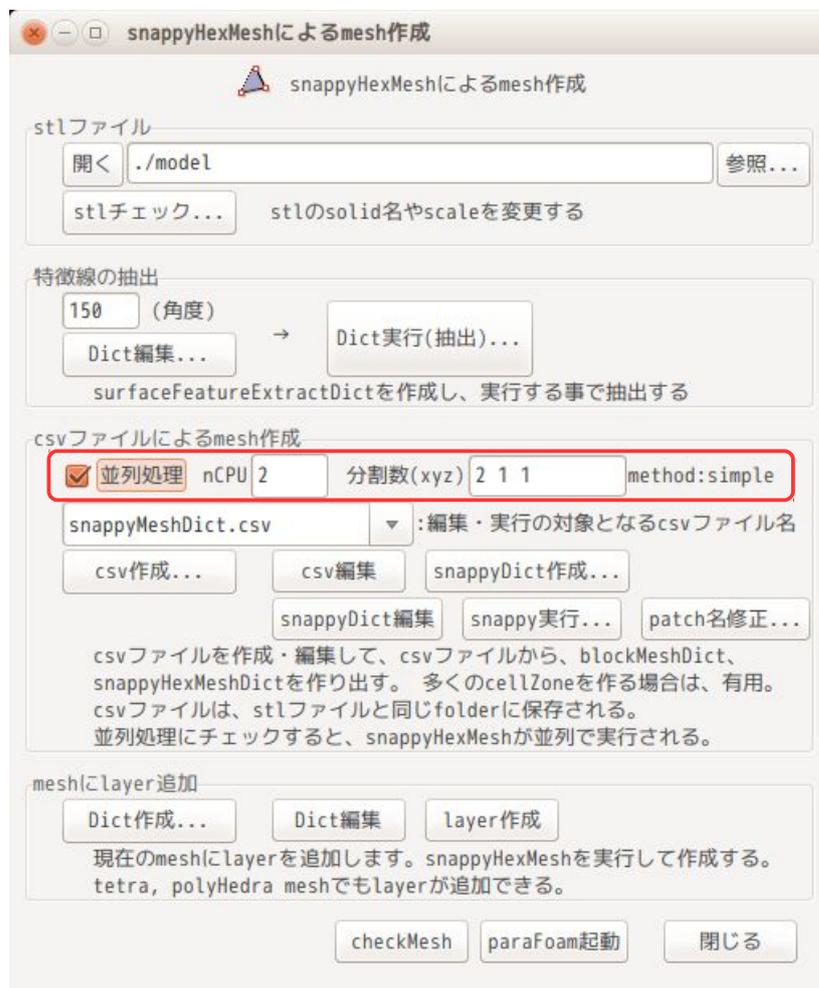
尚、この並列処理は、以下の様に実行しているのので、シングルコアで処理する時と同じ操作で、同じ結果が得られる。しかし、処理のステップが多くなるので、メッシュの要素数が小さいモデルの場合は、並列処理すると、かえって処理時間が長くなってしまふ事がある。(2, 4, 5項が並列処理特有の処理で、シングルコアの場合は、不要な項目になる。)
