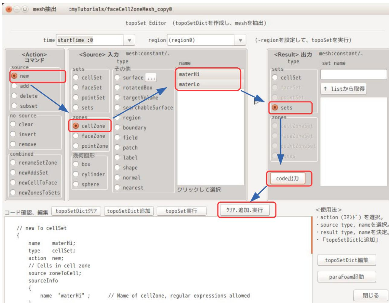
Result type として「sets」を選択しており、これだけでは Result type が cellSet, faceSet, pointSet なのか確定しない事になるが、Source type で cellZone を選択している為、Result type は、「cellSet」に設定される。この様に、Result type は、Source type で決定される事になる。
