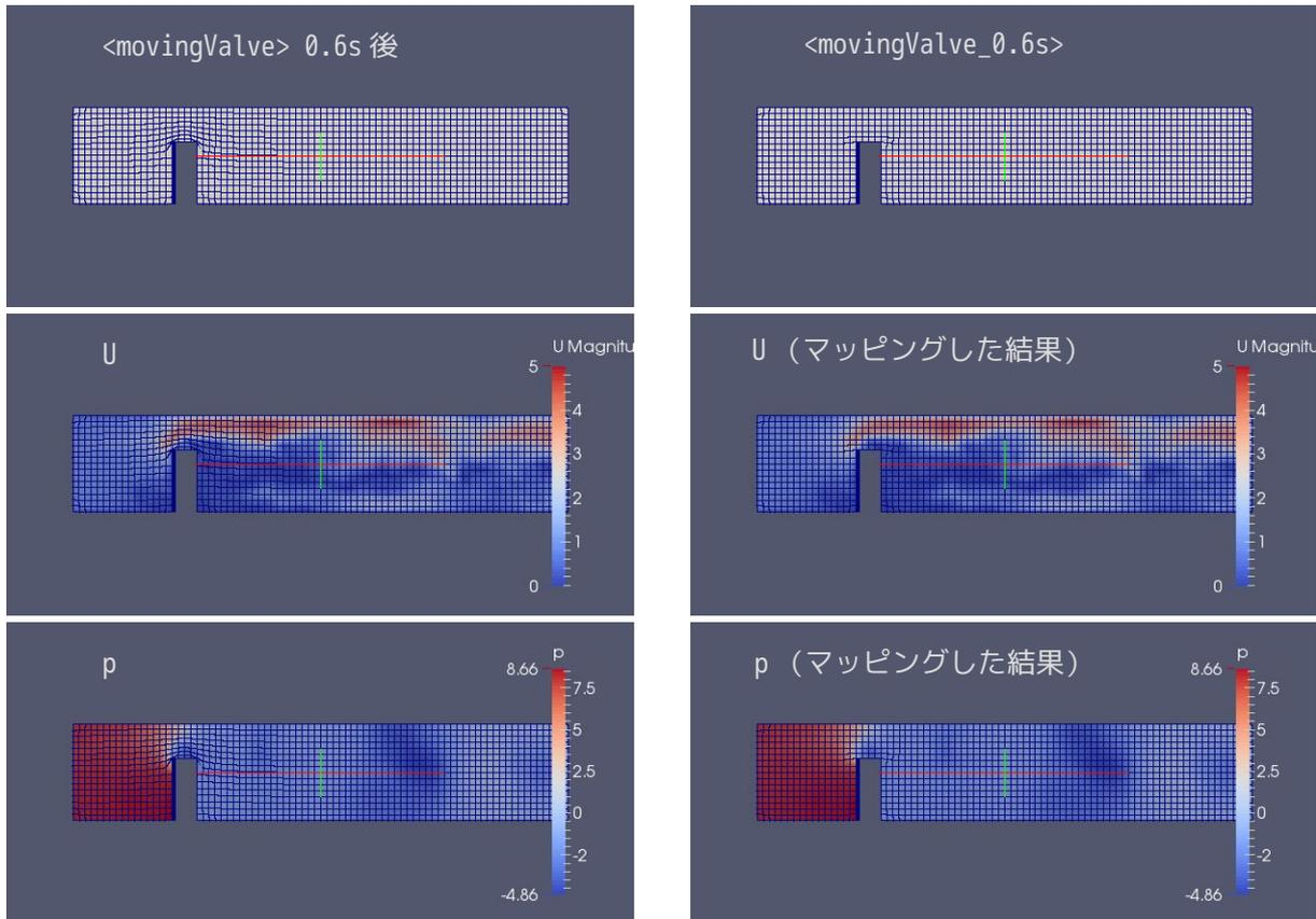
データがマッピングできているので、さらに計算を継続してみる。
