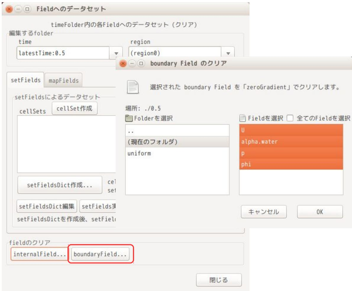
以上の操作で、各 field の boundaryField の内容が全てクリアされ、メッシュとの整合がとれた状態になる。クリアの方法は、boundary ファイルの patchType に応じて以下の様にクリアされる。
