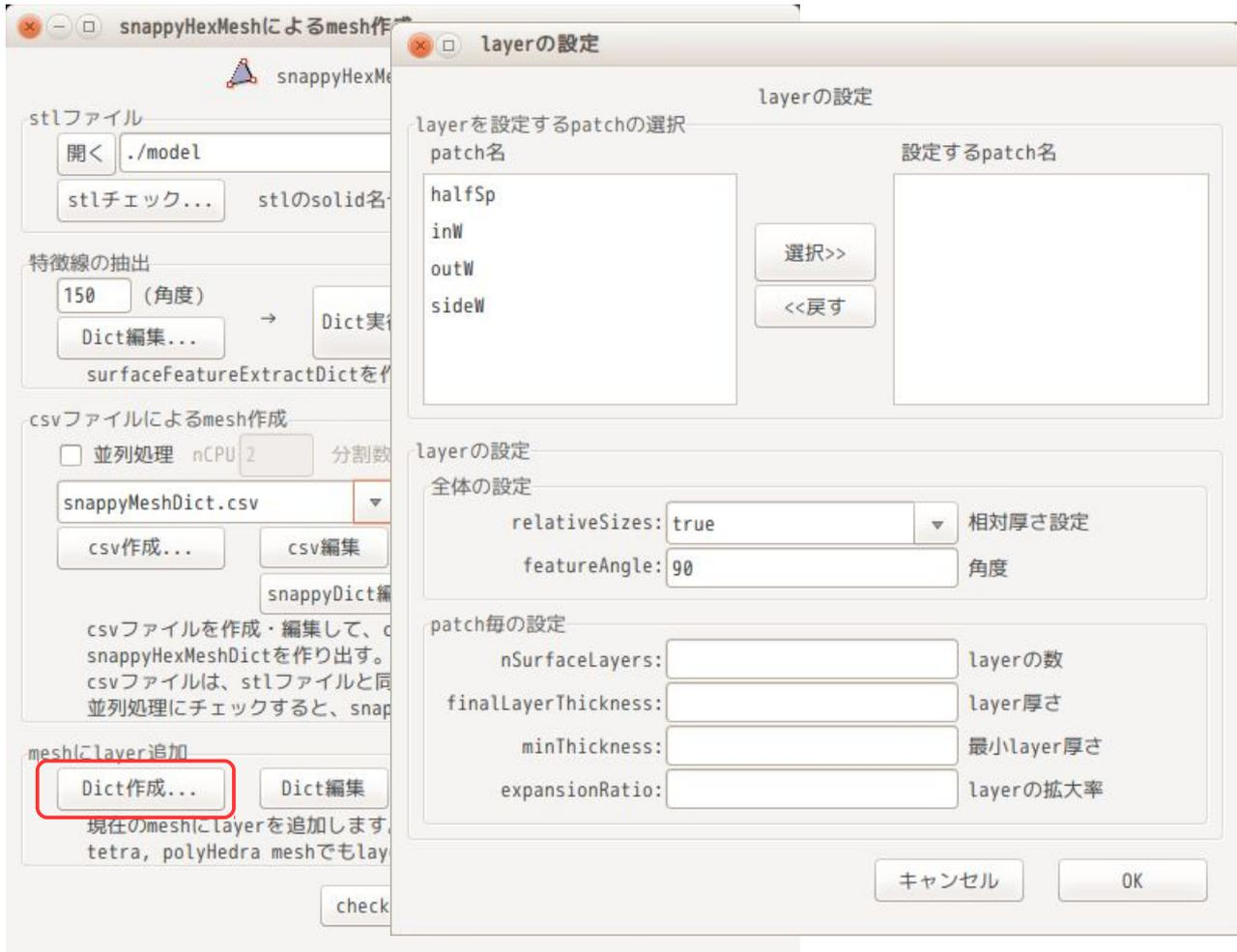
layer を追加する場所は、側面の壁 sideW と半球 halfSp の patch になるので、これらの patch を選択し、「選択>>」ボタンをクリックして、layer を設定する patch 名側に移動する。
