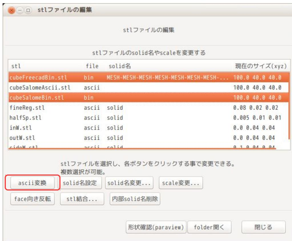
変換が完了すると、以下の様に、ファイル形式が「ascii」に変わる。
