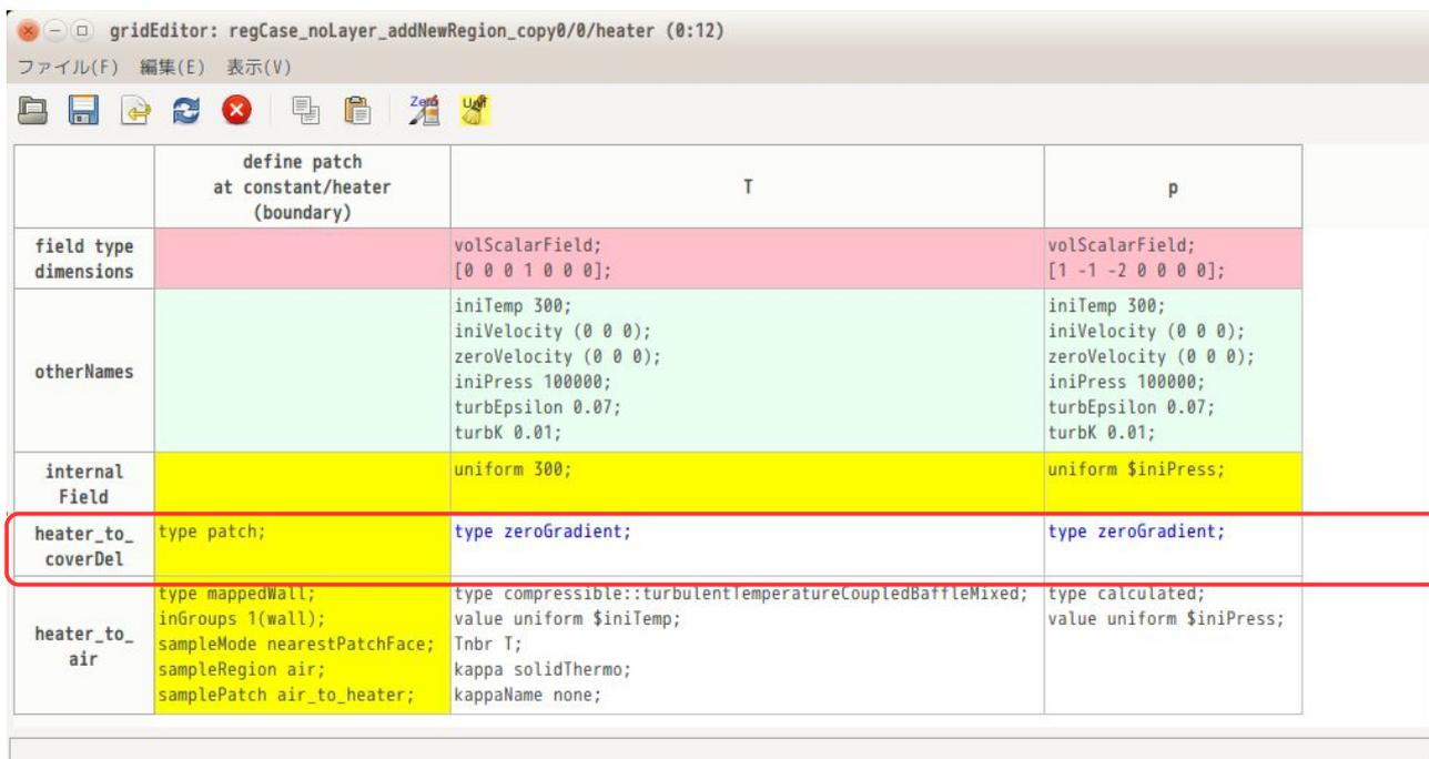
以上の様に cover と接していた patch 名が cover を削除した事により、通常の patchType に変わり、ここの patch 内容が「zeroGradient」に修正される。この為、このまま solver を実行させてもエラーは発生せず、実行できる状態にある。
