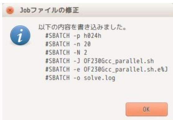
この修正内容は、下図のように、log ファイルを含め#SBATCH 行の全てを設定しているので、「設定」ボタンで全ての項目を設定することができる。
