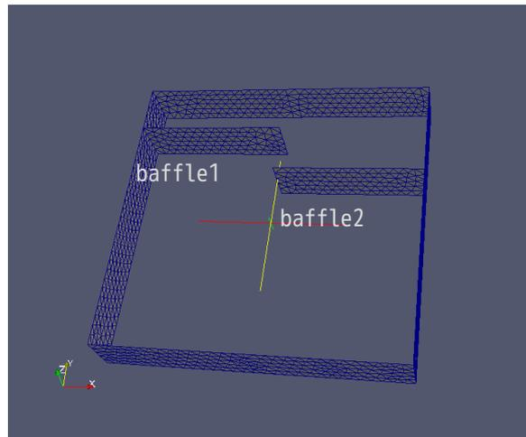
尚、ideasUnvToFoam コマンドでファイル変換 (「ideasUnvToFoam...(faceのみグループ化)」ボタンをクリック) した場合、volume グループ (cellZone) を作っている場合は、エラーが発生していたが、OpenFOAM-2.3.0 以降では、うまく変換してくれた。OpenFOAM の最新版を使う限りは、どちらでも構わない。
