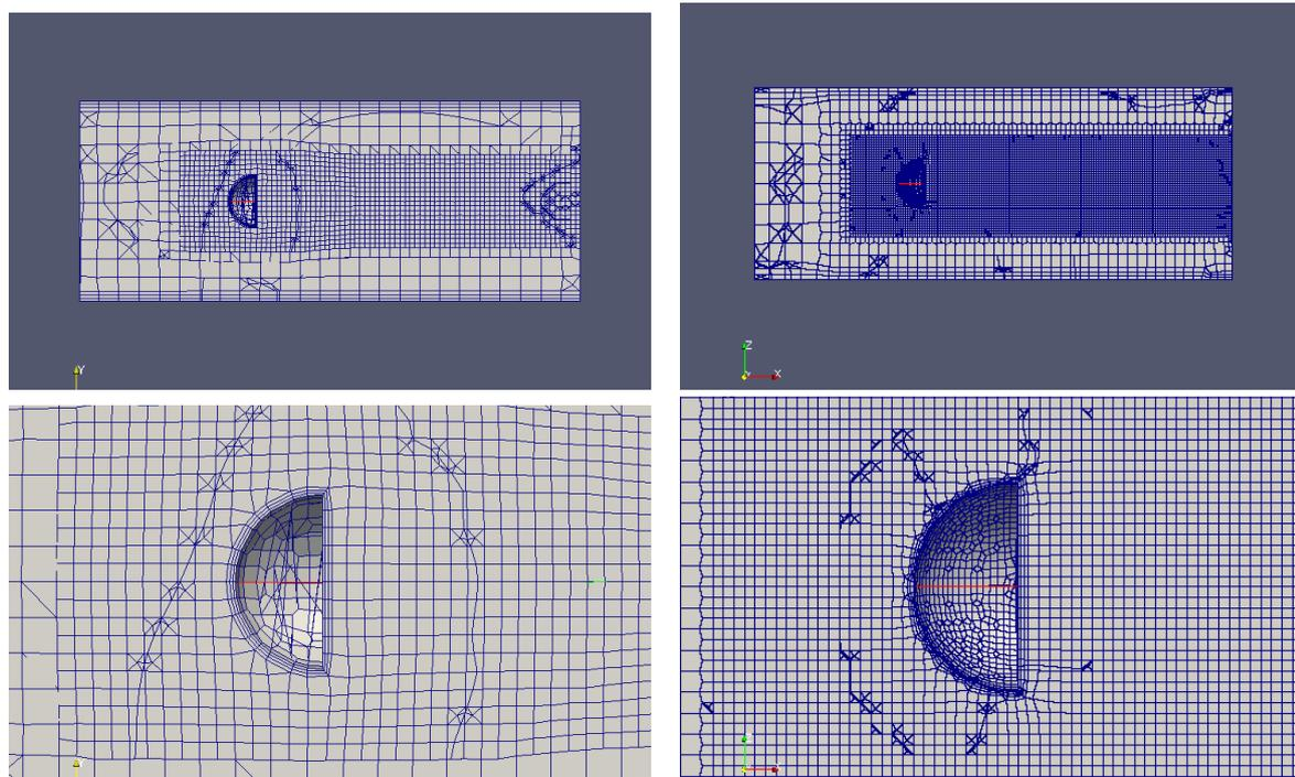
できあがったメッシュを snappyHexMesh と比較すると、fineReg 内のメッシュは、cfMesh の方が細くなっている。半球の halfSp の直径は 10mm の為、1mm でメッシュを切ると、10 分割されるはずだが、cfMesh の方は、倍の 20 分割されている。この状態は、モデルの大きさを 1000 倍に拡大してメッシュを切り直しても同じ状態。この為、メッシュサイズに関しては、指定した通りのメッシュサイズが必ずしも実現できていないので、メッシュ作成後、望みのメッシュサイズになっているか確認する事が必要か。
