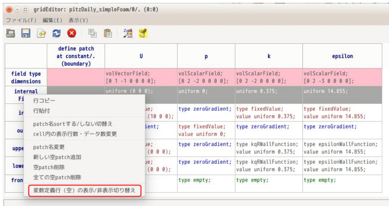
以下が、変数定義行を表示させた状態になる。変数定義行 (水色) が 2 行が表示されている。
