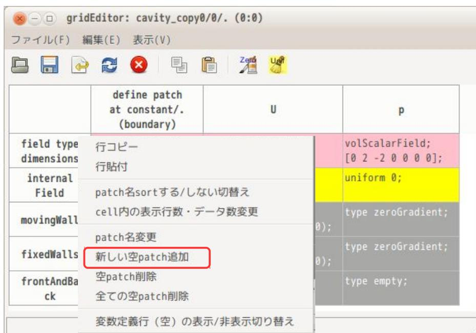
以下は、3 行の空 patch を追加した状態になる。空 patch (face の数が「0」のパッチ) は、黄色で表示される。また、追加と同時に各 field の boundaryField の整合性も取るので、空 patch の boundaryField には、「zeroGradient」が設定される。
