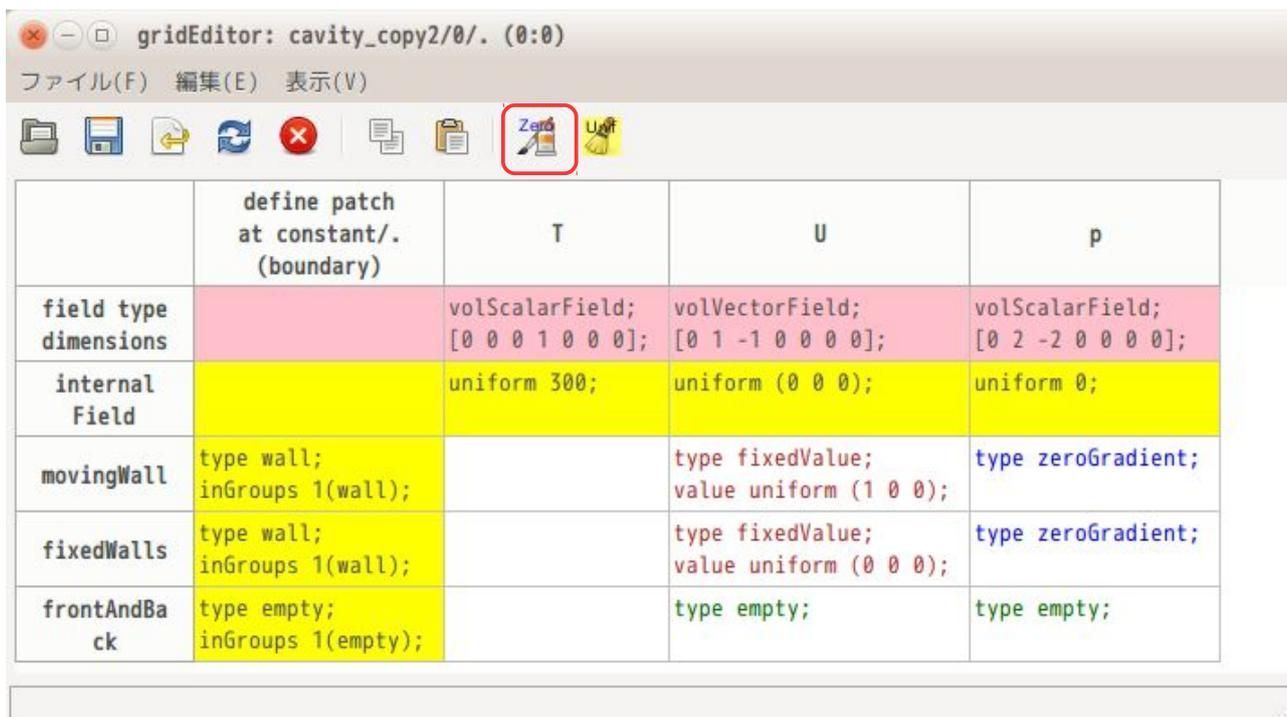
以下は、Zero ボタンをクリックした状態になる。空白セルが boundary の patchType に応じた cell 内容で埋められている。(今回の場合は、「zeroGradient」と「empty」で埋められている。)
