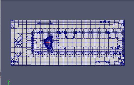
今回は、レイヤの設定として「maxThickness」(第1層の最大厚さ)の項目を指定せずにレイヤを設定したが、これを指定してレイヤを作成してみる。以下が maxThickness の設定有無でレイヤを比較した結果になる。
