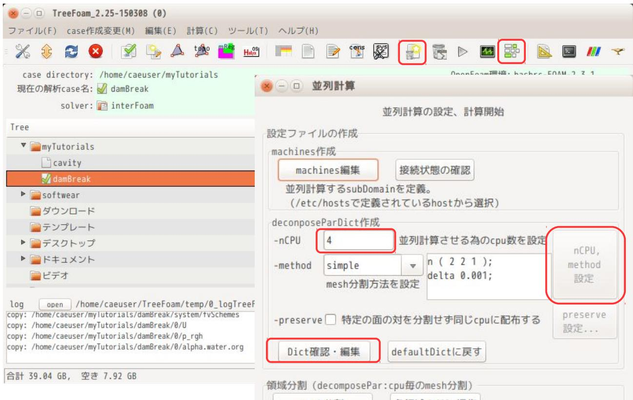
また、同時に mesh 分割方法 (method) も確認できるので、確認する。今回の場合、simple の (2 2 1) で設定されていることが確認できる。分割方法や分割数を変更するのであれば、ここで直接修正する。修正後は、「nCPU,method 設定」ボタンをクリックして、decomposeParDict に反映させる。
