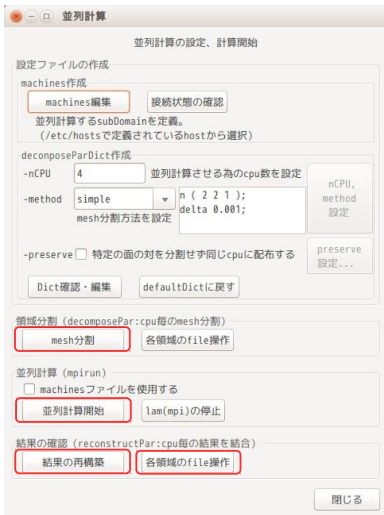
計算結果を再構築した後は、各 processor 毎の計算結果は不要になる。これを削除する為に「各領域の file 操作」ボタンをクリックすると、下図の「processor 内の file 操作」画面が現れるので、この画面上で削除するフォルダを選択し、一括して削除できる。各 processor 内の time フォルダは、基本的に最初と最後のみ残しておけば、問題ない。これらを残しておくと、結果ファイルの容量が2倍になってしまう。
