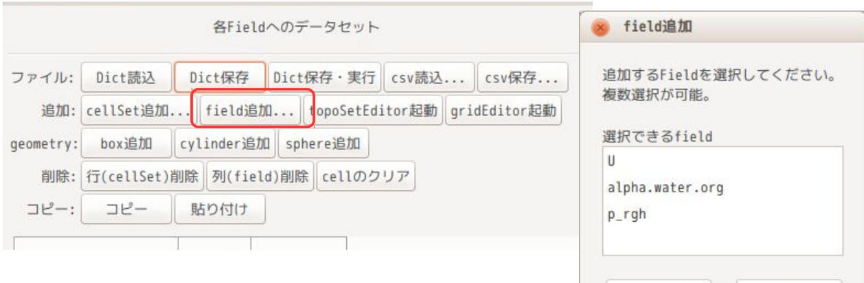
以上の操作を行って、cellSetとfieldを追加した結果が以下になる。新たに cellSet「waterMiddle」と field「U」が追加されている。
