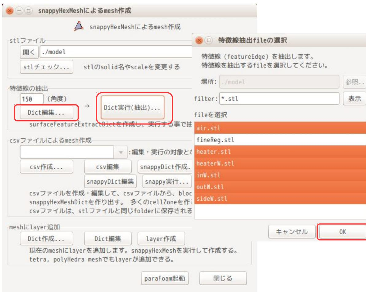
特徴線を抽出した後は、「snappyHexMeshによるmesh作成」画面上の「csv作成...」ボタンをクリックして、以下の様に、メッシュ作成用のデータを作成する。
