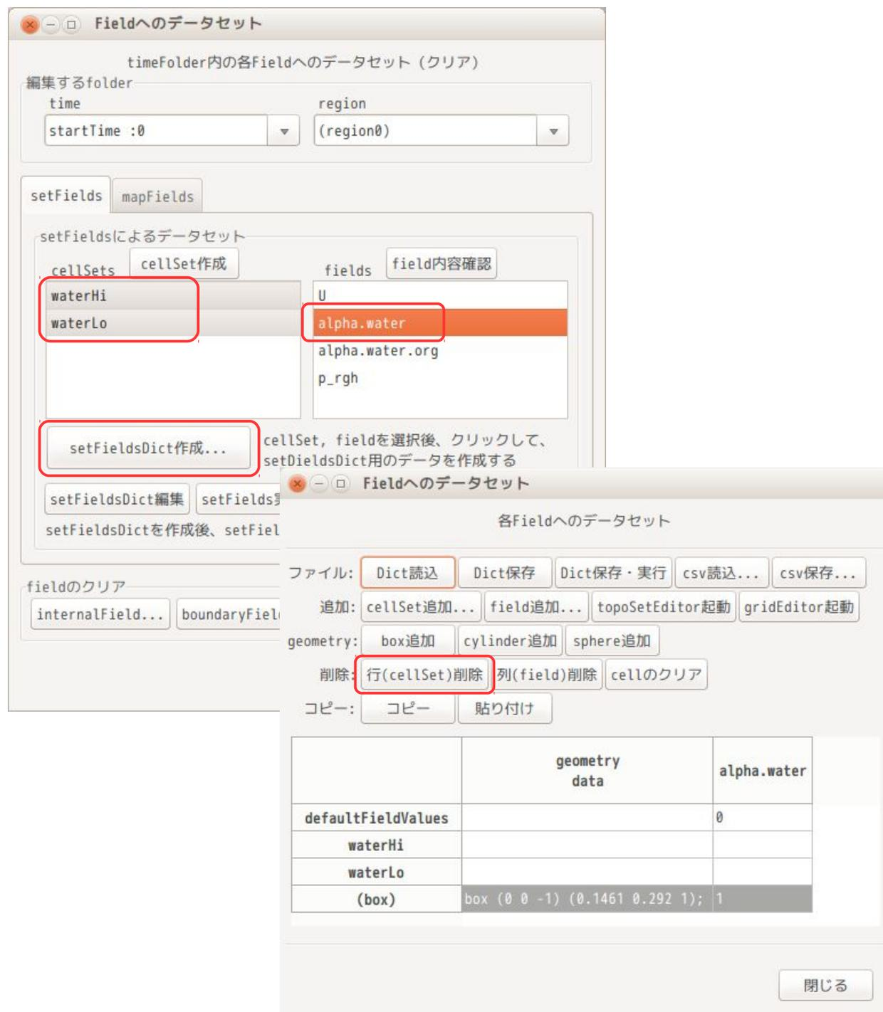
現れた画面上には、現在設定されている setFieldsDict の内容が表示されている。(damBreak で使用している setFieldsDict は、box を使ってデータをセットしているので、(box)行が表示されている。)
