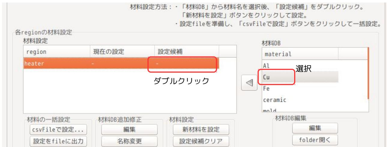
この状態で、Cu 材が設定候補として設定されたので、この材料を region に設定する為に、以下の様に「新材料を設定」ボタンをクリックする。この操作で、Cu 材が heater に設定されたことになる。
