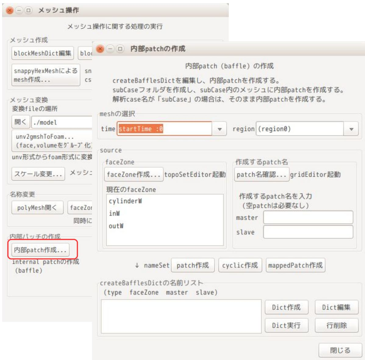
内部 patch は、faceZone を元に作成するので、前記「内部 patch の作成」画面が表示された時点で、いま存在している faceZone のリストが表示されている。
