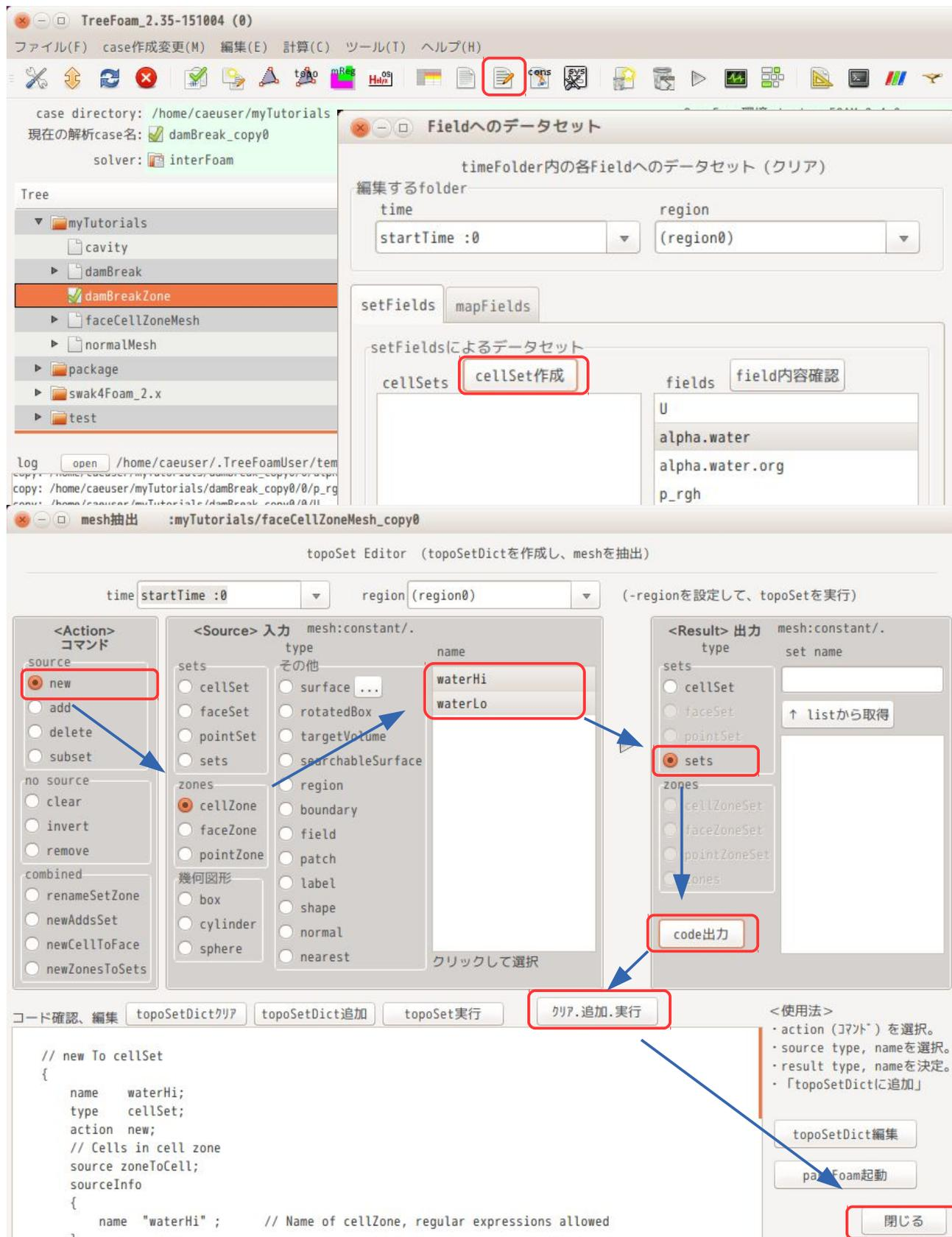
「fieldへのデータセット」画面に戻ると、cellSets内に「waterHi」と「waterLo」が取得できているので、これらと、値をセットするfield (alpha.water) を選択し、「setFieldsDict作成...」ボタンをクリックする。
