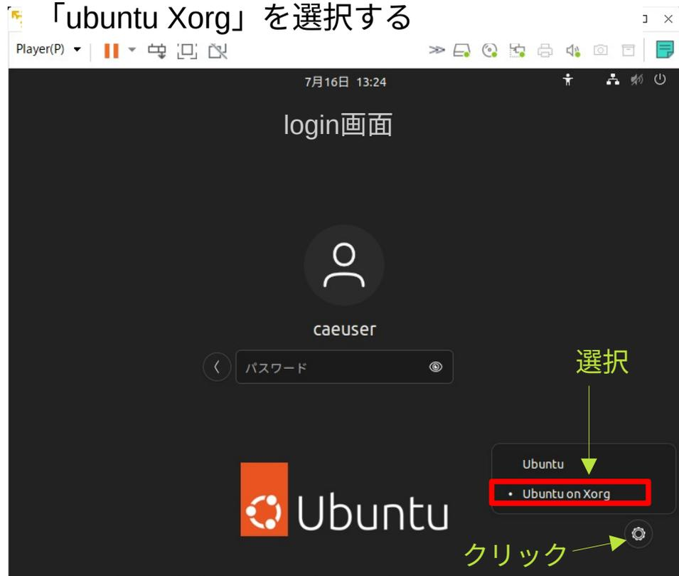
起動後、ディスプレイサーバが「wayland」 or 「X11」を確認する方法は、「設定」を起動し、「このシステムについて」タグを選択し、ウィンドシステムの内容で確認できる。右の例では、「X11」が確認できる。
