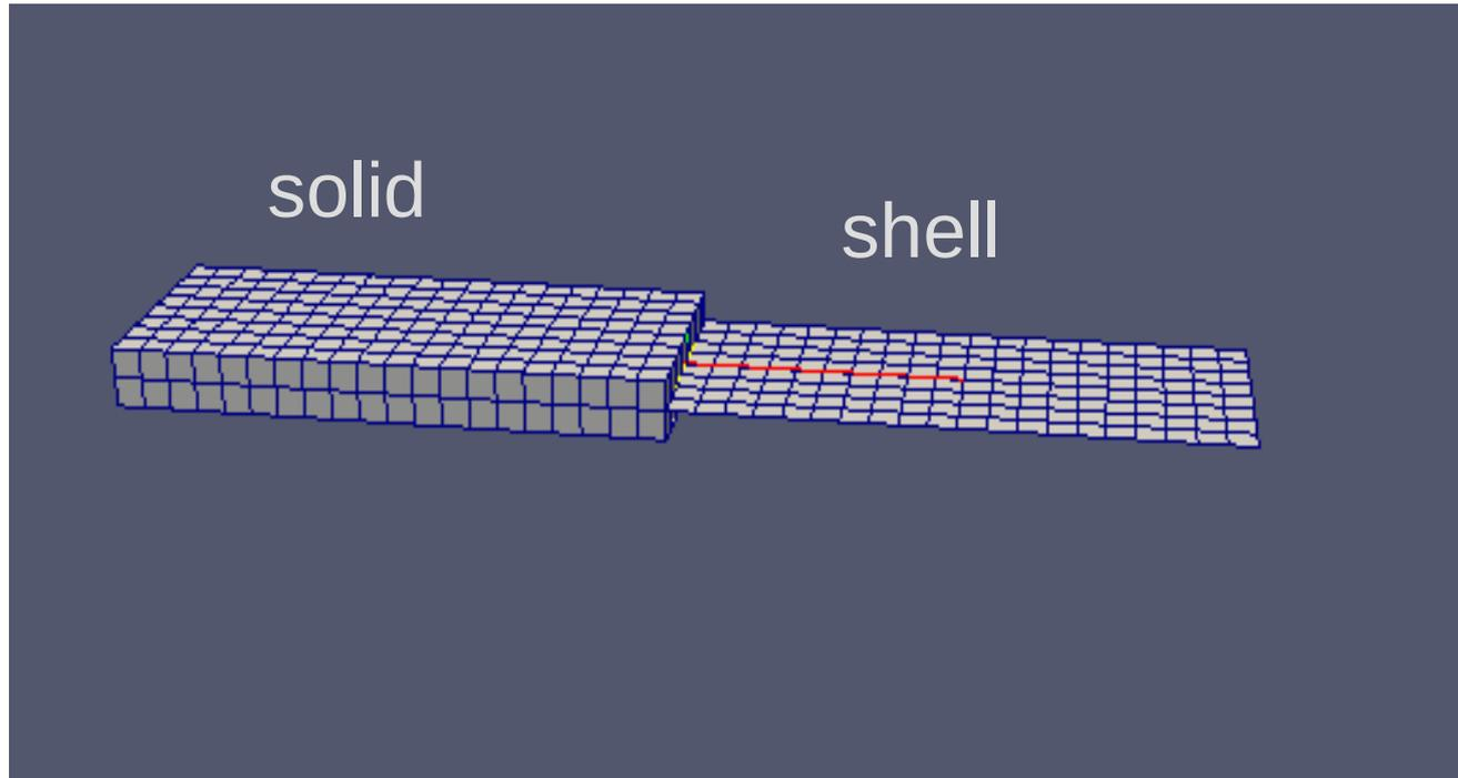
solid接続面の節点と、shellの接続線の節点間の関係式を設定して、dummy節点に回転角を設定する。
